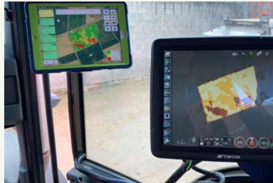
El Visor en cabina, mostrando el mapa de la parcela en tiempo real.
