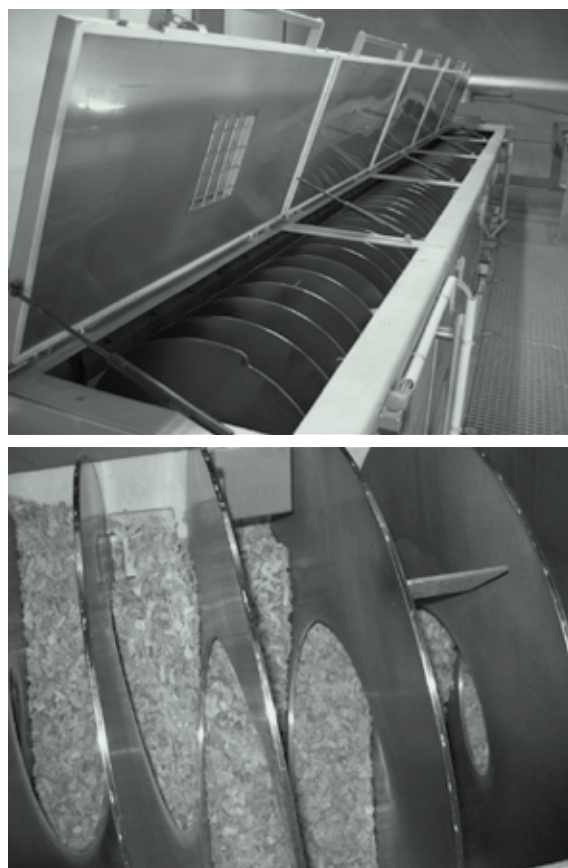
Figura 15 Detalle del túnel de secado automático por tostado resistivo (Spirajoule™) de PRONEKTAR
